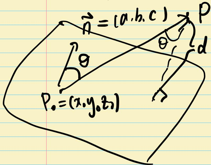
$$\begin{aligned} \text{Cof)} \quad & \vec{P_0P} \cdot \vec{n} \\ &= \|\vec{P_0P}\| \|\vec{n}\| \cos \theta \\ d &= \left| \|\vec{P_0P}\| \cdot \cos \theta \right| \\ &= \left| \frac{\vec{P_0P} \cdot \vec{n}}{\|\vec{n}\|} \right| \\ &= \left| \vec{P_0P} \cdot \frac{\vec{n}}{\|\vec{n}\|} \right| \quad \square \end{aligned}$$
